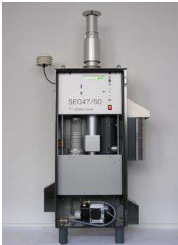
Obrázok 10: Vzorkovací systém, ktorý je súčasťou mobilnej meracej stanice
