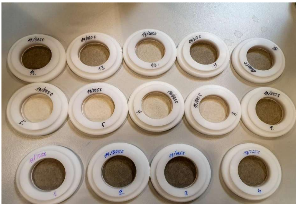
Obrázok 7: Exponované filtre po ukončení merania v zimnom období (poradové číslo na držiaku filtra označuje poradové číslo dňa tzn. 1. je 14.2.2023, 2. je 15.2.2023 atď.)
