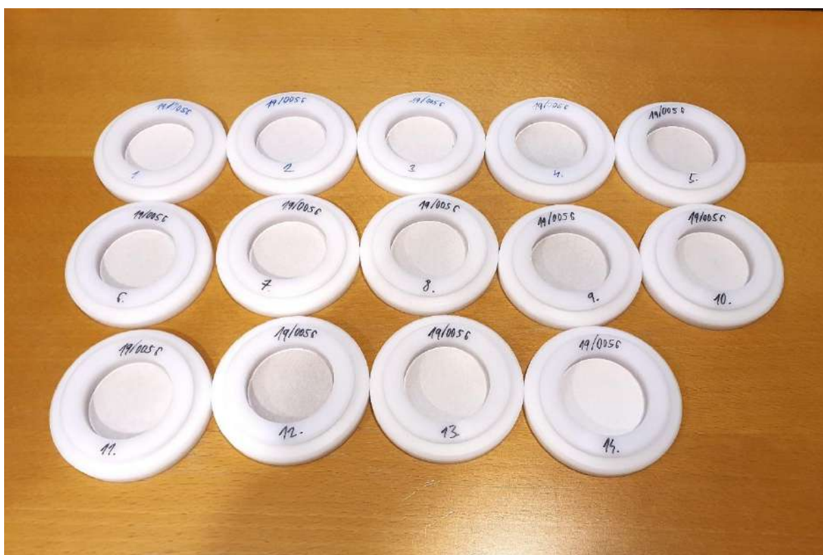
Obrázok 8: Exponované filtre po ukončení merania v letnom období (poradové číslo na držiaku filtra označuje poradové číslo dňa tzn. 1. je 13.7.2023, 2. je 14.7.2023 atď.)
