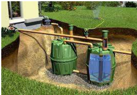
akumulačné nádrže podzemné
